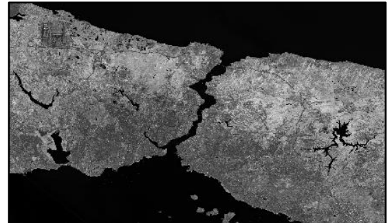
Image en niveaux de gris de la bande B8 (proche infrarouge). La végétation a une forte réflectance (teinte claire) tandis que la réflectance de l’eau est très faible (noir).
